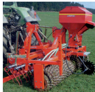
Le Greenmaster 3m pour la régénération des prairies de chez Gütler était présent à la Foire agricole.
